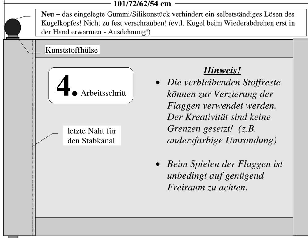
**Neu** – das eingelegte Gummi/Silikonstück verhindert ein selbstständiges Lösen des Kugelkopfes! Nicht zu fest verschrauben! (evtl. Kugel beim Wiederabdrehen erst in der Hand erwärmen - Ausdehnung!)
